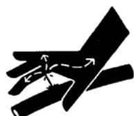
Não verifique vazamentos no circuito hidráulico com as mãos, pois a alta pressão pode provocar grave lesão.
